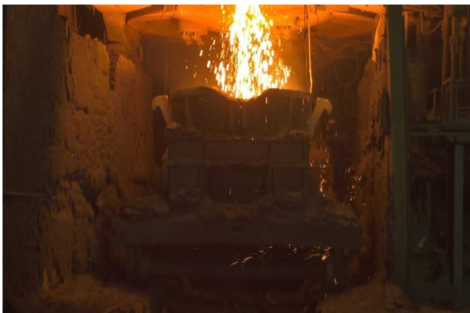
Рисунок 2.55 — Слив шлака под печь в шлаковую чашу
