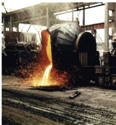
Рисунок 7.13 — Шлаковоз-миксер вместимостью 36 м 3
