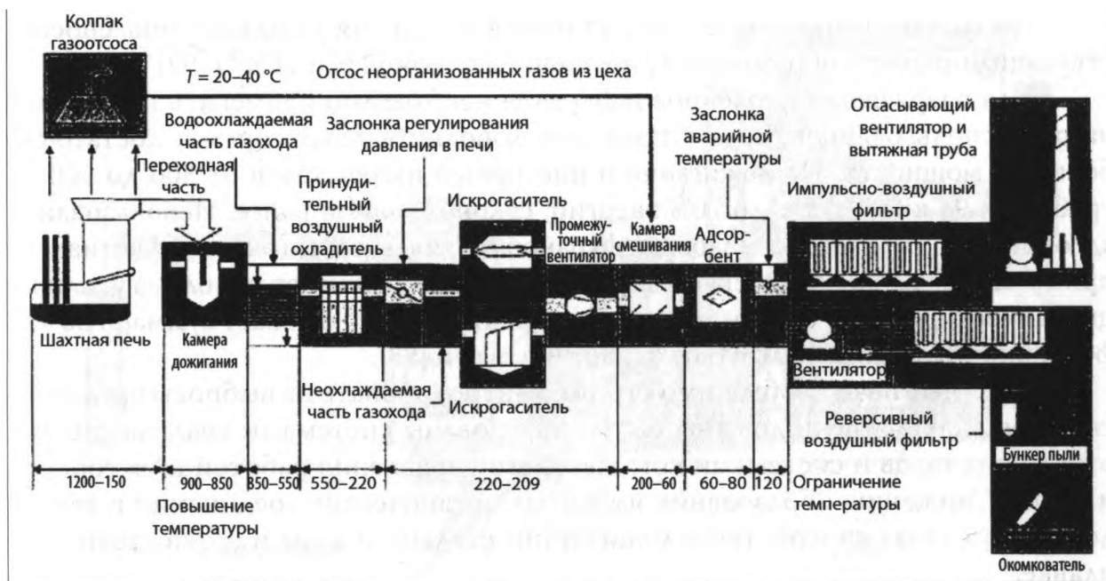
Рисунок 2.59 — Современная технологическая схема системы газоочистки шахтной дуговой печи
