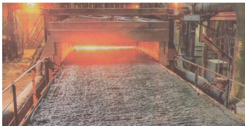
Рисунок 2.11 — Выход аглоленты со спечённым агломератом из-под зажигательного горна
