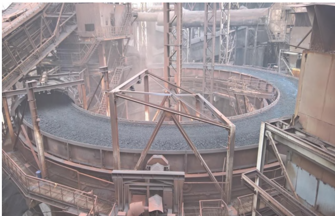
Рисунок 2.15 — Кольцевой охладитель агломерата
