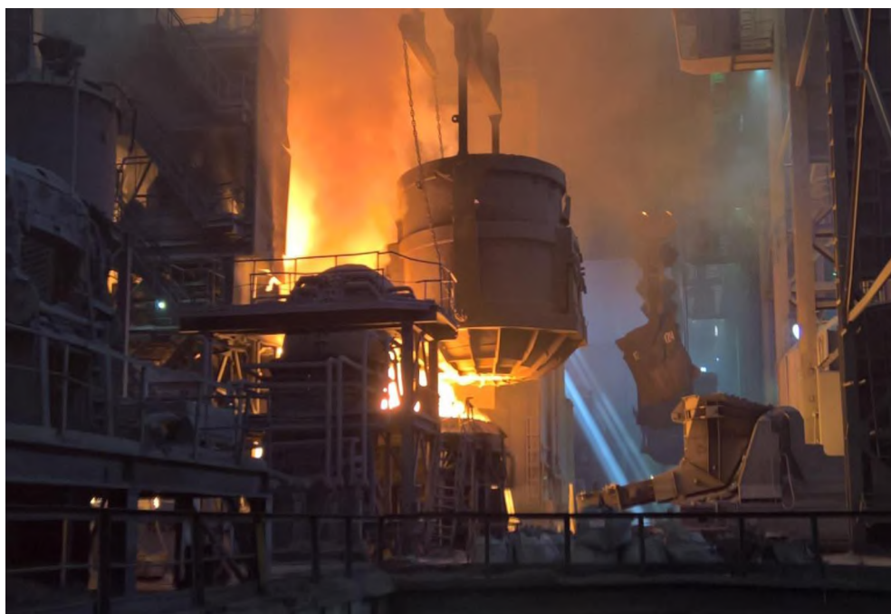
Рисунок 2.52 — Завалка шихты бадьей в ДСП-180, рядом на манипуляторе находится желоб для заливки чугуна, на кране висит ковш с чугуном
