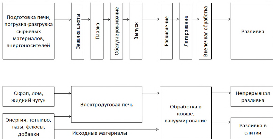
Рисунок 2.46 — Технологический процесс производства стали в ДСП, заготовок и слитков
