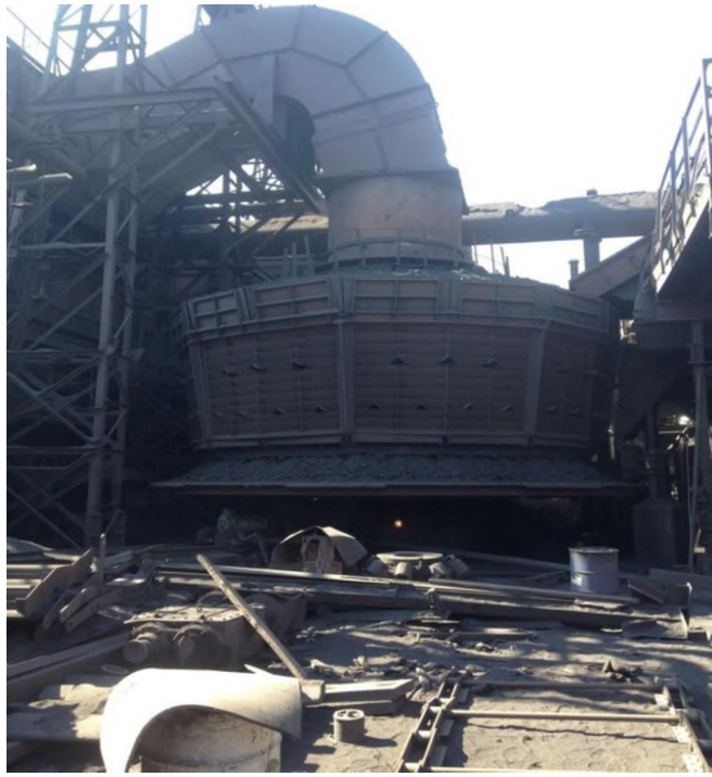
Рисунок 2.13 — Чашевый охладитель агломерата с прососом воздуха модернизированный
